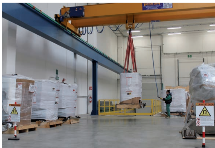
La movimentazione di apparecchiature medicali pesanti è effettuata attraverso un carroponte in grado di sollevare sino a 16 tons, perfettamente inserito nel ciclo logistico
