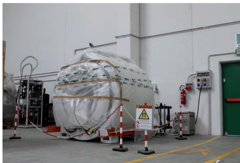
Il magazzino di Casirate d'Adda è dotato di sei impianti per il mantenimento in attività, sino alla data di consegna alle strutture ospedaliere, di altrettante risonanze magnetiche
